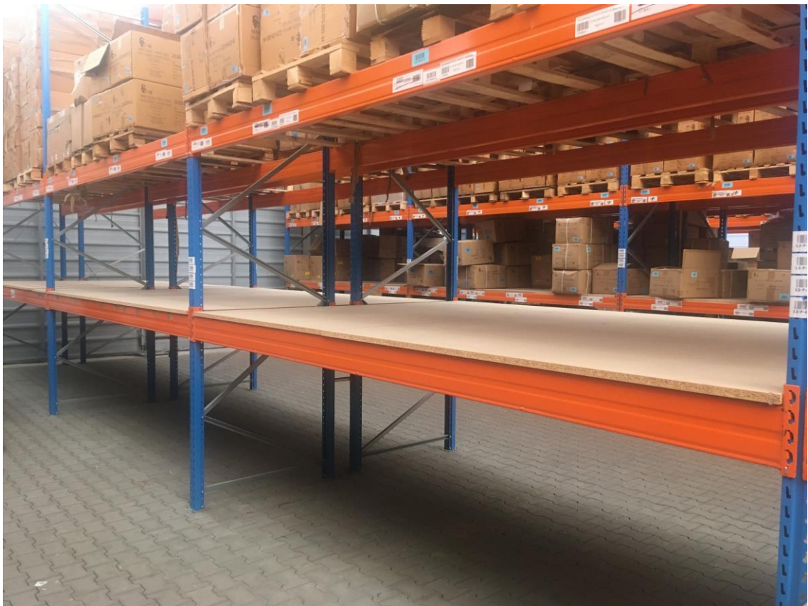
Obrázek 8 Rozdělené první patro paletového regálu pro vychystávání (vlastní zpracování)
