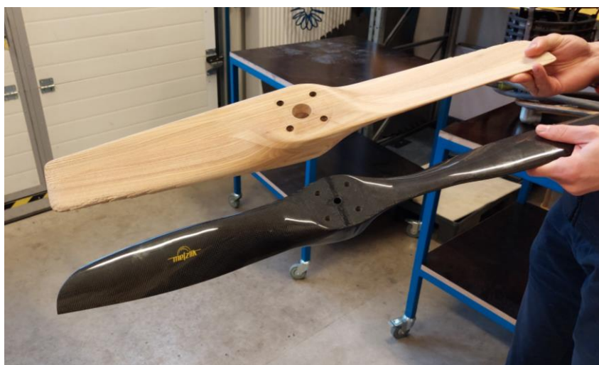
Obr. 3 Vrtule z uhlíkových vláken a ze dřeva
