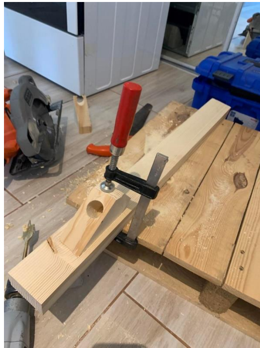
Obrázok 26 Vrtanie otvorov pod uhlom
