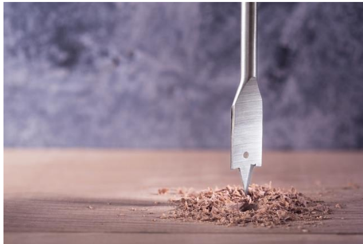
Obrázok 16 Vrtanie sukovníkom (Pojar, 2022)
