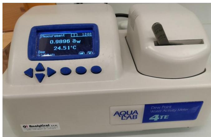
Obrázek 6 Měření vodní aktivity, vlastní fotografie
