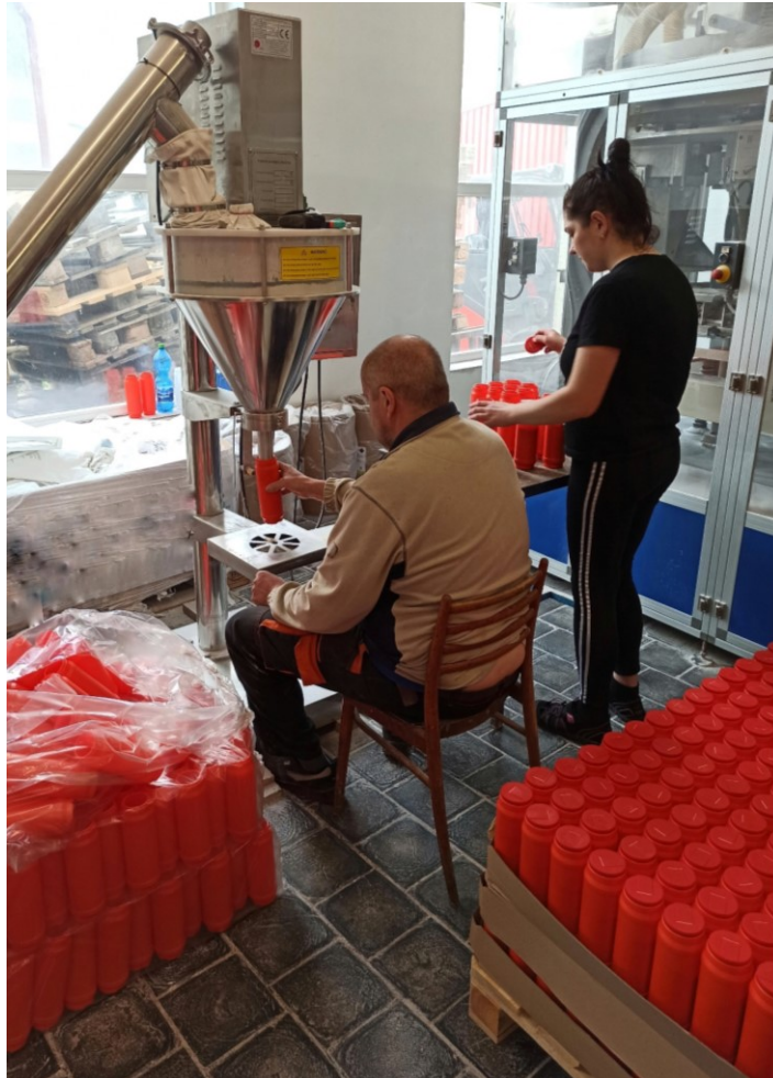
Obrázek 13 Procesy plnění dóz a aplikace uzávěrů (vlastní zpracování)
