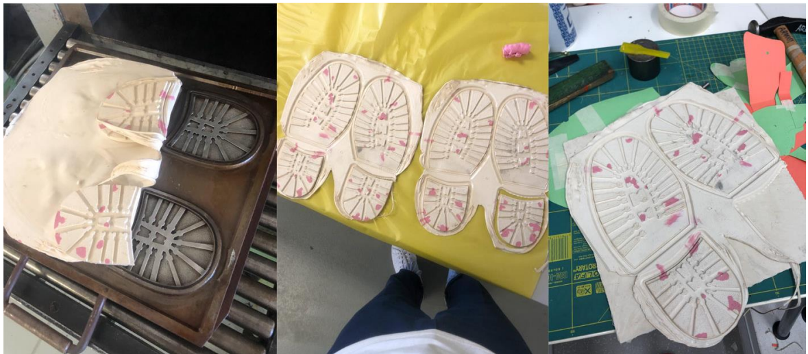
Obrázek 10 proces výroby pryžových podešví
