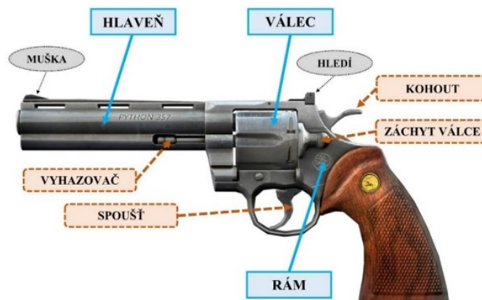
Obrázek 2: Hlavní a ovládací části revolveru [1].
