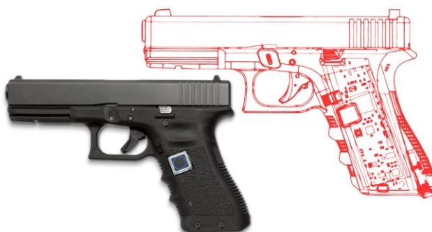
Obrázek 33: Pistole s čtečkou otisku prstu [28].
