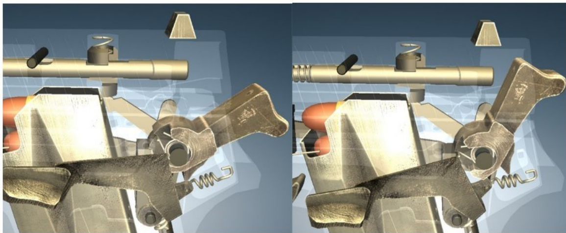
Obrázek 51: Konstrukce a funkce vypouštěcí páky [6].
