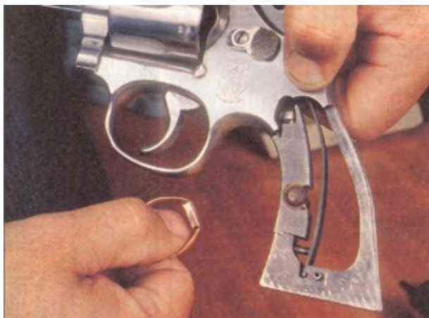
Obrázek 31: Vnitřní konstrukce magnetické pojistky [25].
