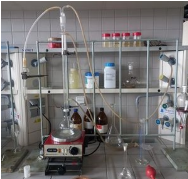
Obr. č. 11. Esterifikace v inertní atmosféře N_2
