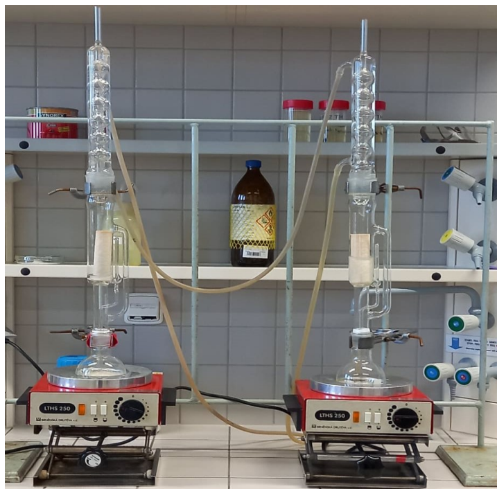
Obr. č. 10. Aparatura Soxhletovy extrakce
