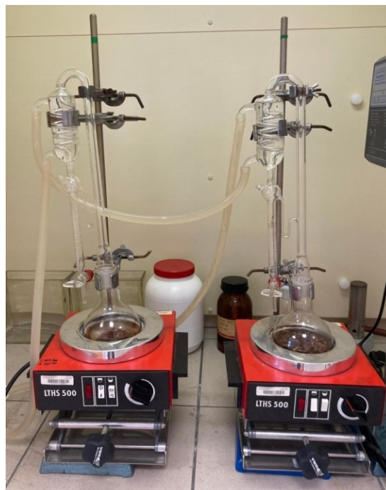
Obrázek 15 Aparatura podle Friedrichse pro hydrodestilaci skořice a hřebíčku
