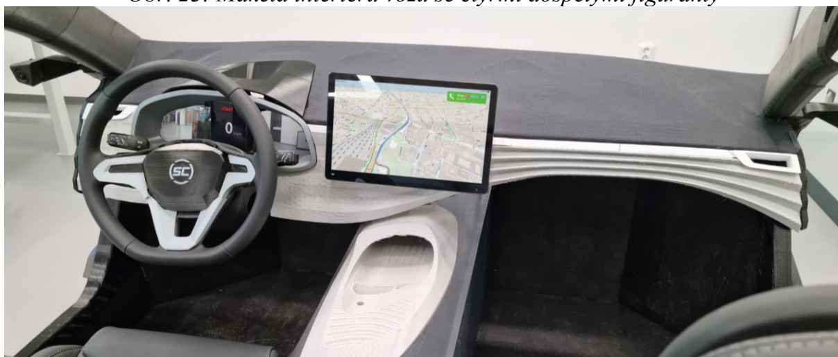
Obr. 24: Fyzická realizace makety interiéru s funkčními prvky
