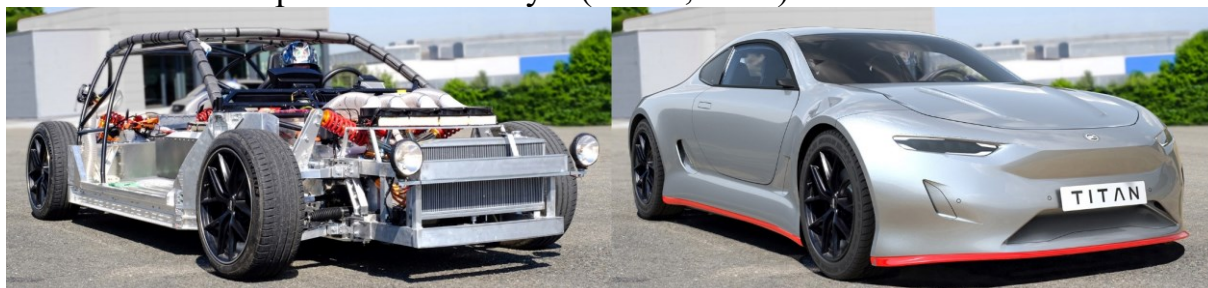
Obr. 36: Pojízdná podvozková platforma Titan a vizualizace karoserie
