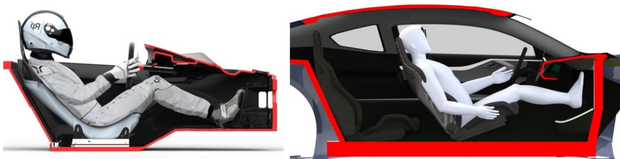
Obr. 22: Interiér závodního kokpitu navržený a uzpůsobený pro přežití případné havárie ve vysoké rychlosti [9] a Řez interiéru vozu Titan – plánovaná pozice spolujezdce
