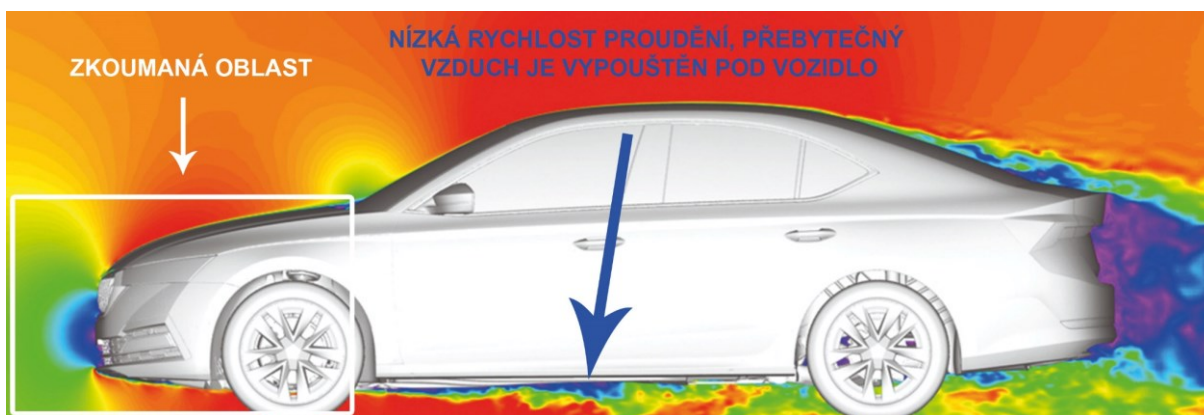
Obr. 32: Simulace proudění vzduchu kolem vozu Škoda Octavia IV [18] upraveno
