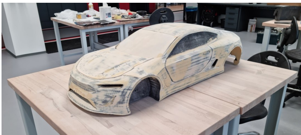
Obr. 59: Vybroušení první vrstvy polyesterového tmelu
