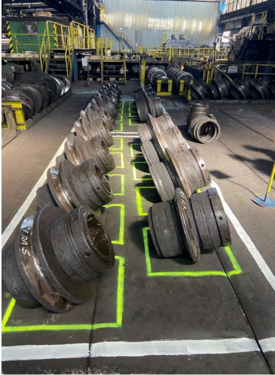
Obrázek 9 Pracoviště výměny válců po realizaci návrhu (vlastní zpracování)
