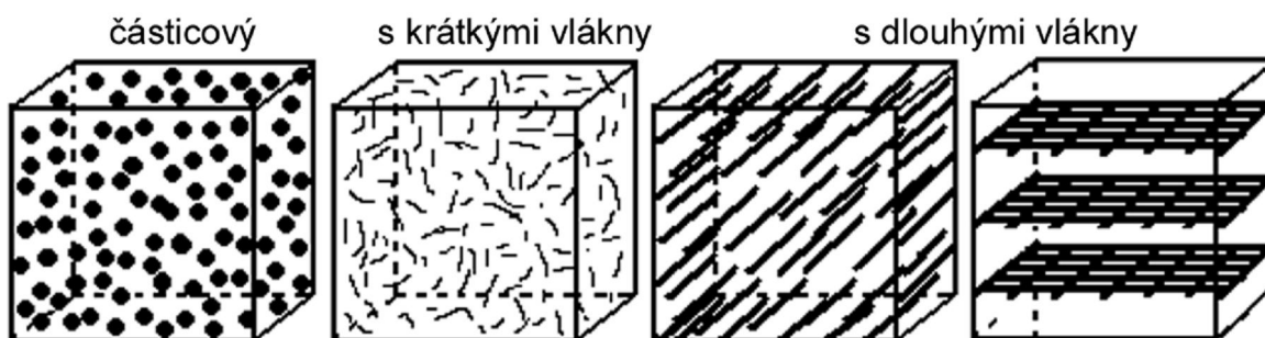
Obr. 1 Kompozity s různými typy výztuže [10]
