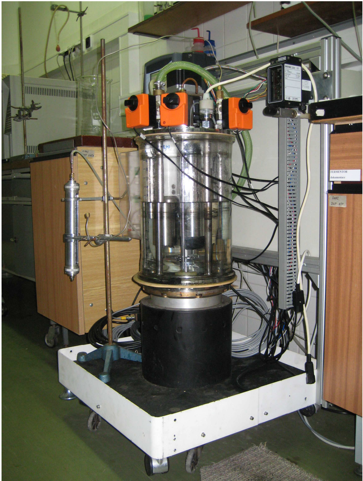
PI – Fotografie bioreaktoru využitého v diplomové práci
