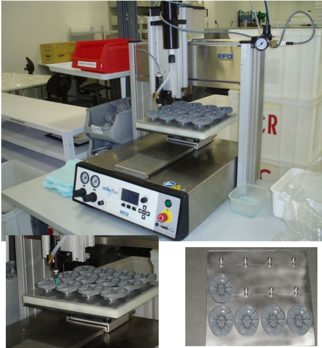
Obrázok 30. Nanášanie lepidla robotom Ultra TT na dielce uložených na prípravku
