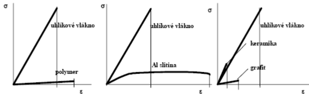
Obr. 1. Schematické znázornění rozdílů v křivkách tahového napětí \sigma - poměrné prodloužení \varepsilon různých matric v porovnání s tahovým chováním standardního uhlíkového vlákna z PAN.
