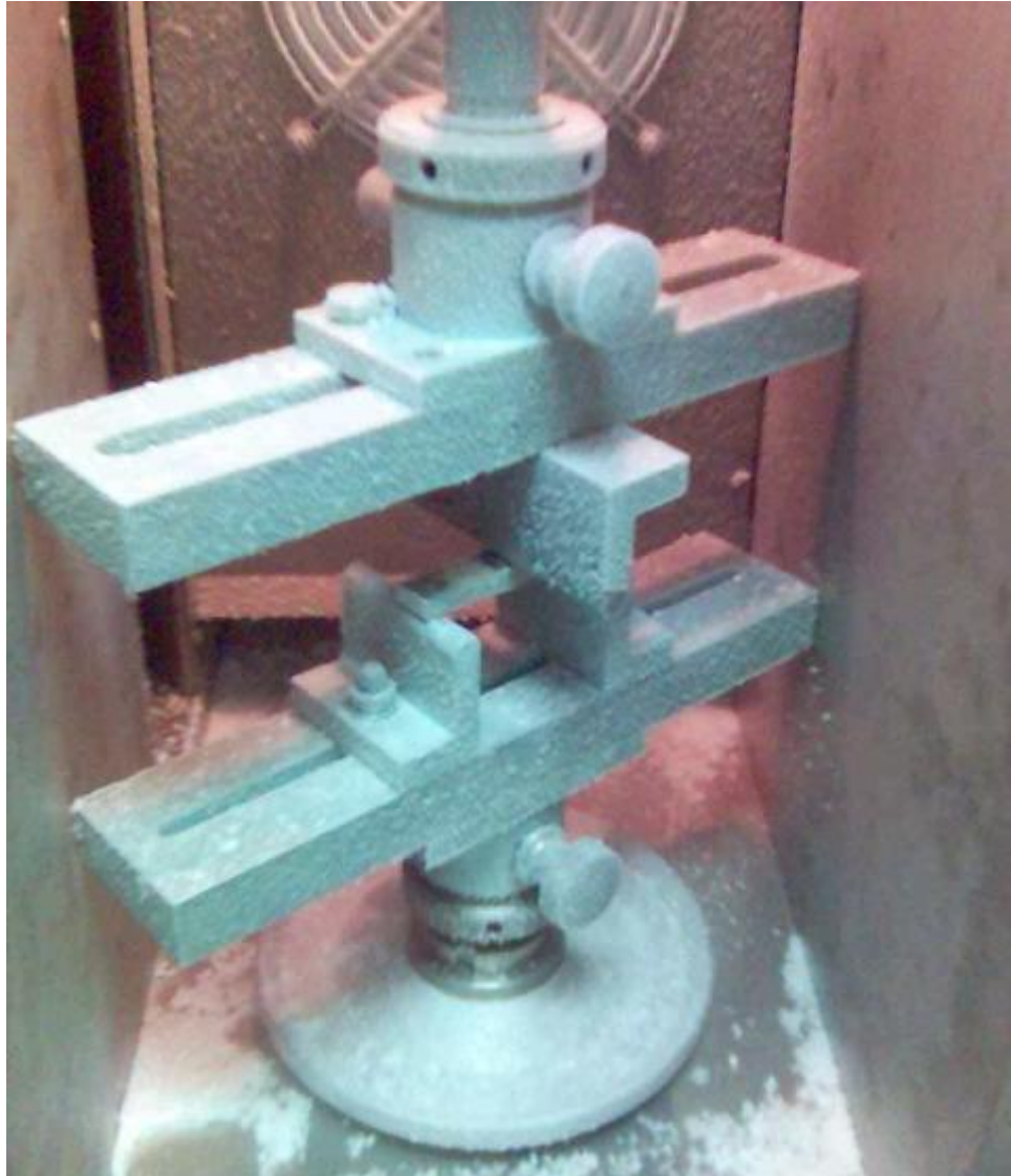
Obr. 29. Ohybová zkouška při - 30 °C
