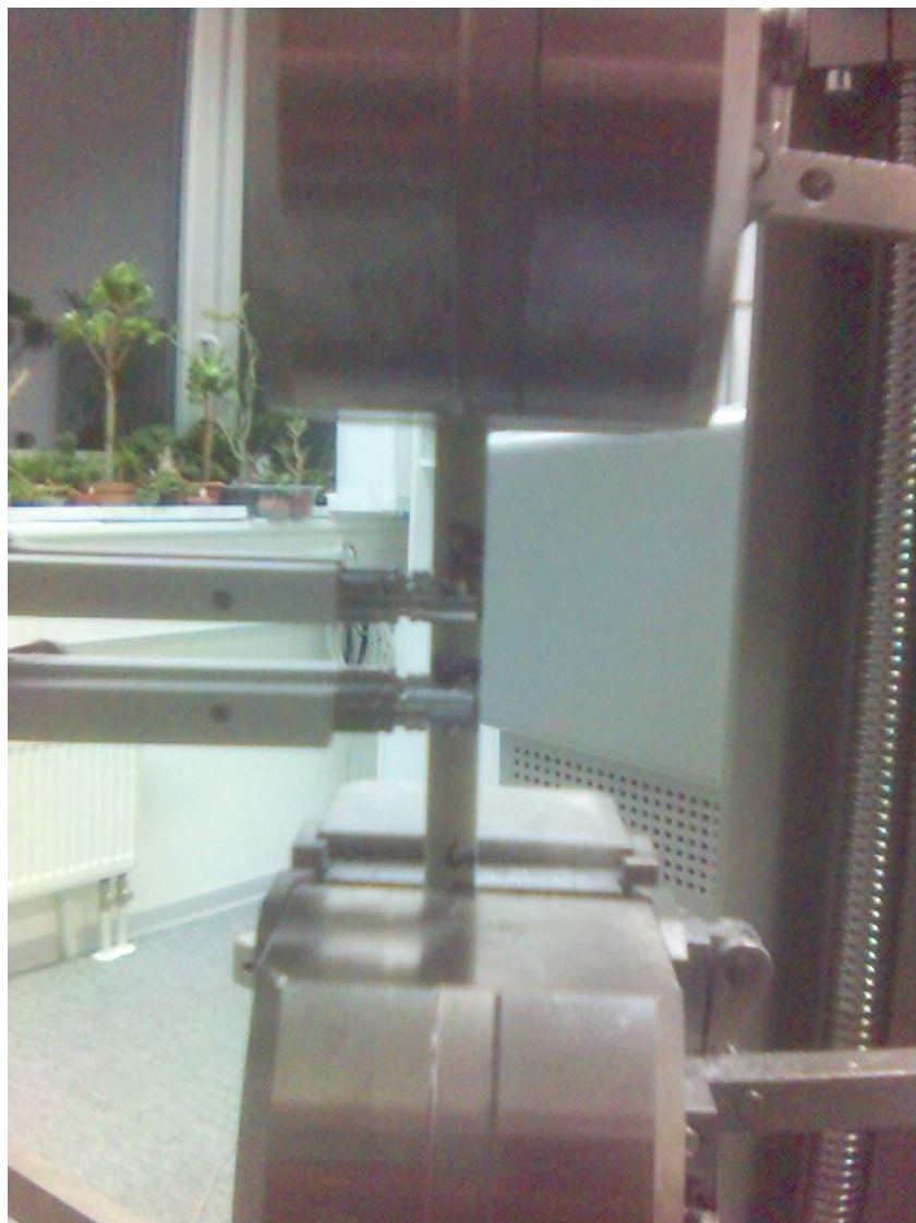
Obr. 19. Zkouška tahem- připojený extenzometr
