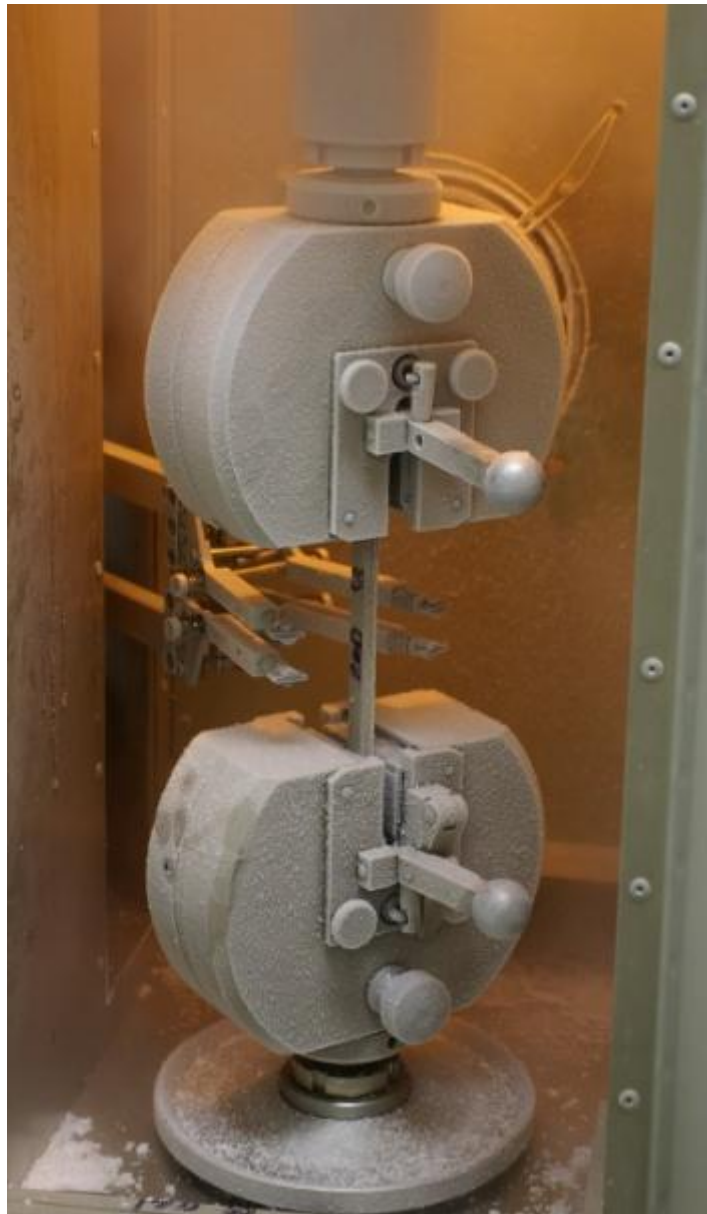
Obr. 20. Tahová zkouška při - 30 °C
