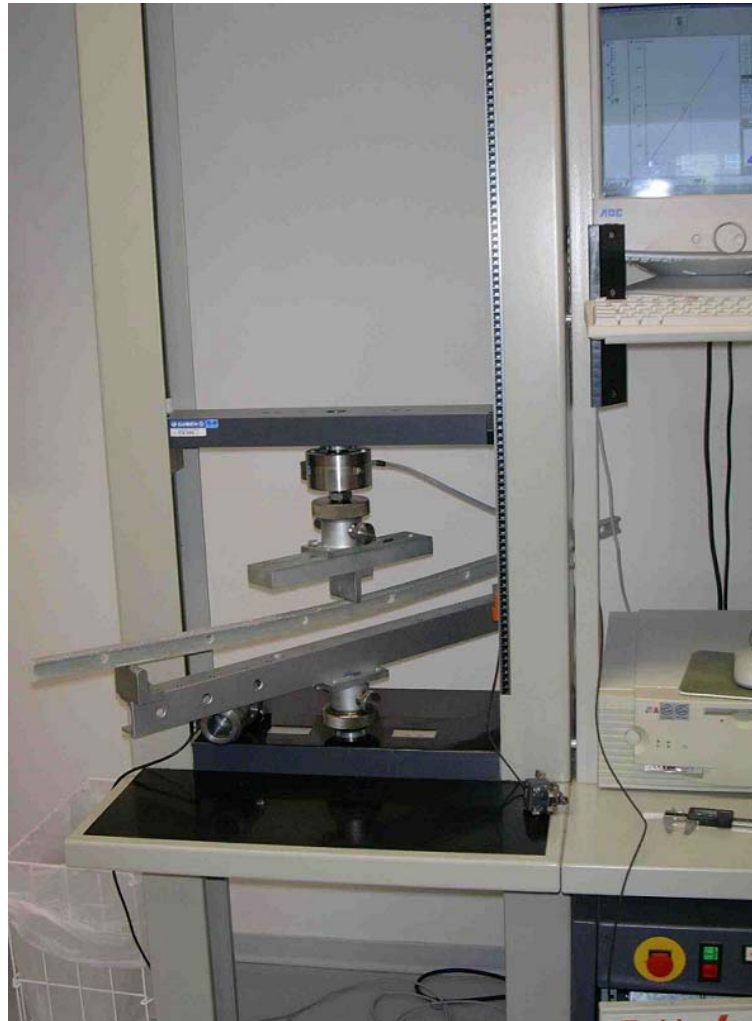
Obr. 12. Fotografie průběhu ohybové zkoušky profilu I, délky 1000 mm na stroji ZWICK
