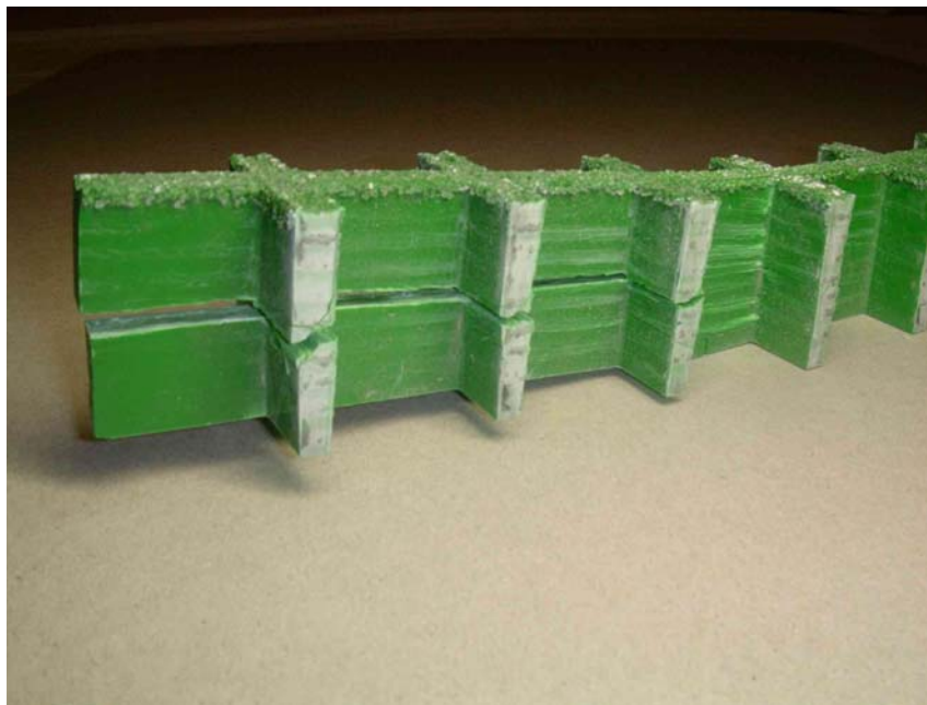
Obr. 22. Fotografie porušené části roštu ze série č. 3
