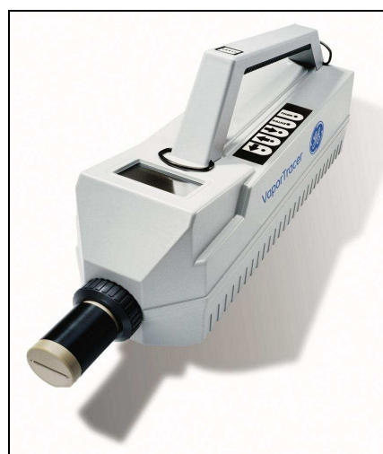
Obr. 31. Přenosný detektor drog VaporTracer [45]
