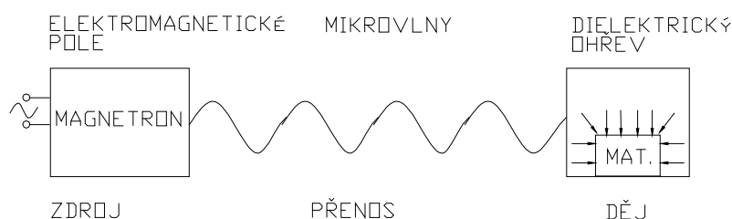
Obr. 33. Princip DE ohřevu
