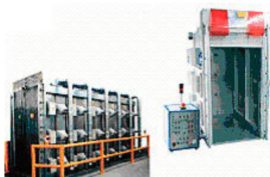
Obr. 23. Vlevo velká stacionární sušička 21 m 3 /30 kW, vpravo mobilní zkušební komorová sušička 4 m 3 /14 kW
