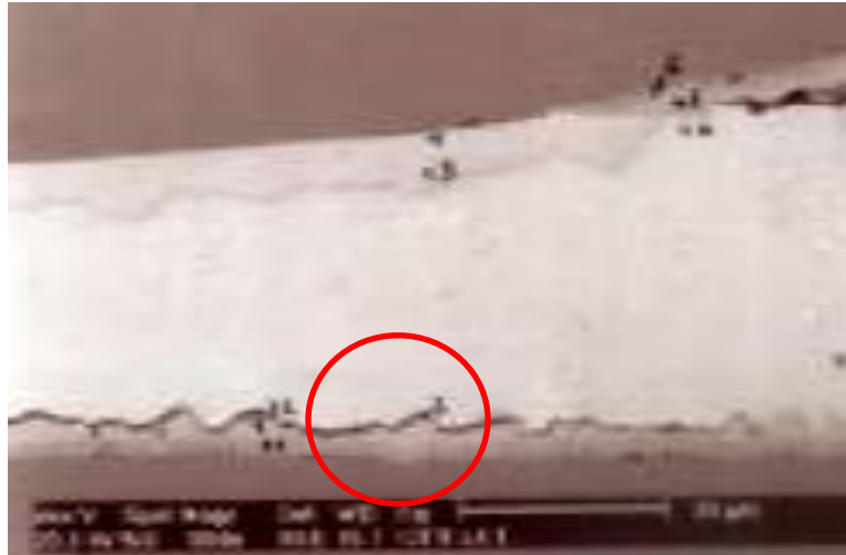
Obr. 39. Šířící se trhlina
