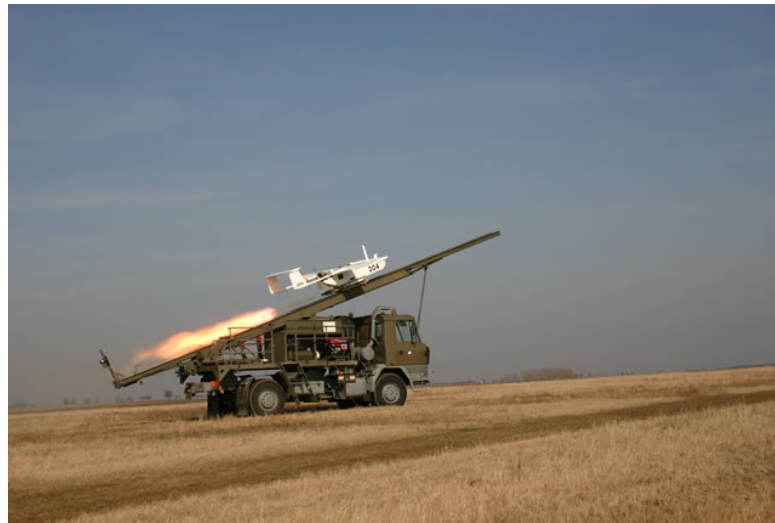
Obrázok č. 12: Štart UAV Sojka III z odpaľovacej rampy
