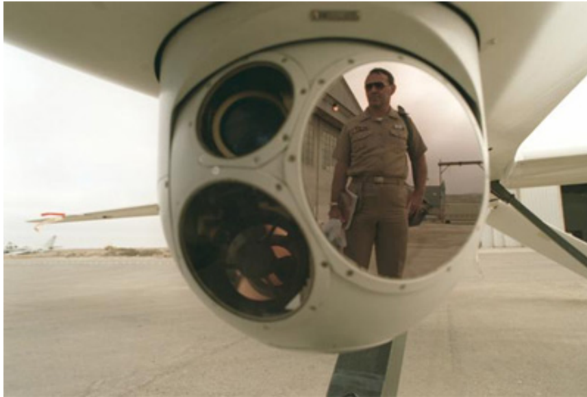
Obrázok č. 19: Vežička so senzormi a kamerami UAV
