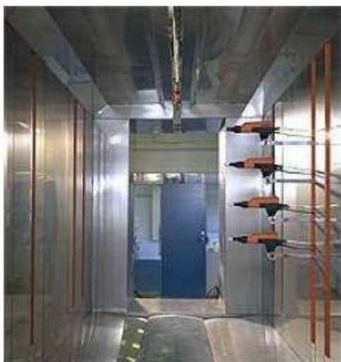
Obr. 12 Prášková lakovací linka [29]
