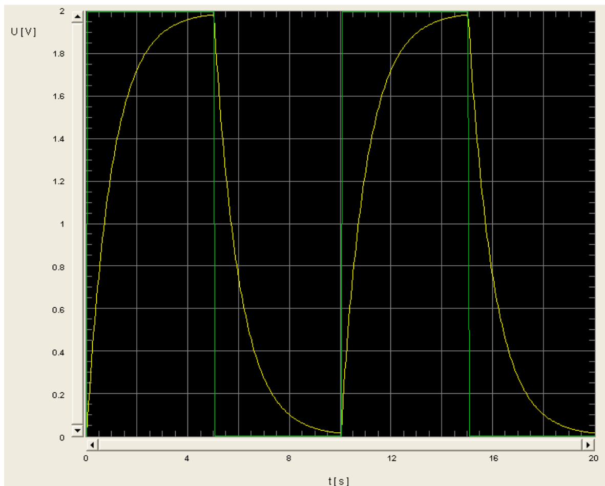
Obr. 35 – Ukázka přechodového děje integračního článku v simulačním prostředí
