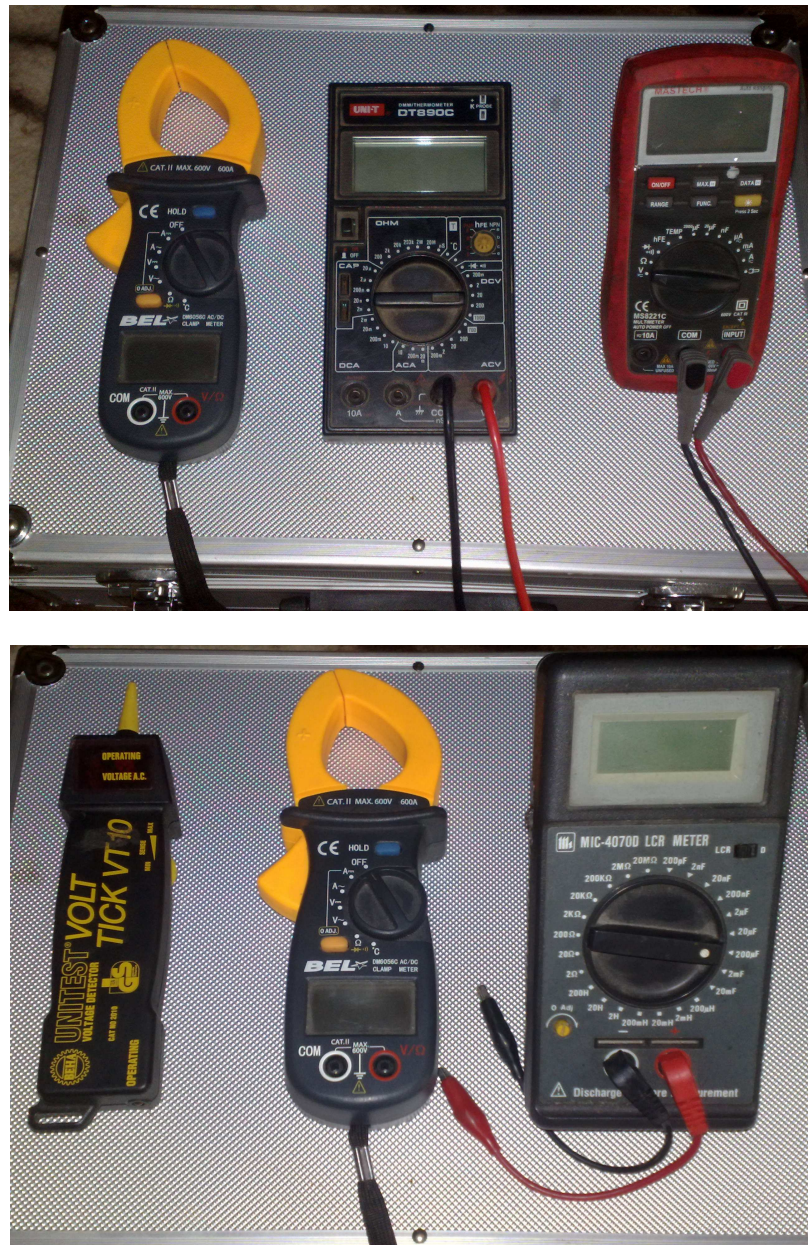
Obr. 4 Používané měřicí přístroje žáků k odstranění závad
