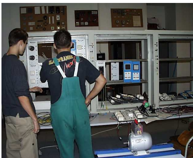
Obr. 12 Měření izolačního stavu elektromotoru
