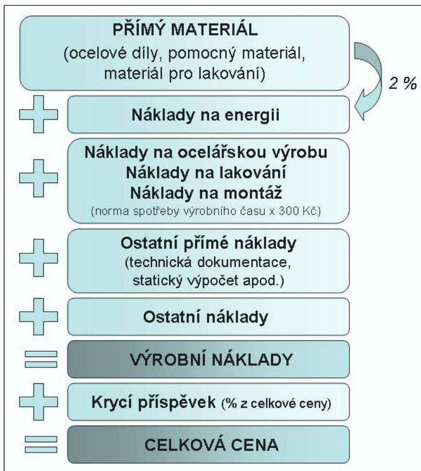
Obr. 13 Schéma stávajícího kalkulačního vzorce [Zdroj: vlastní]
