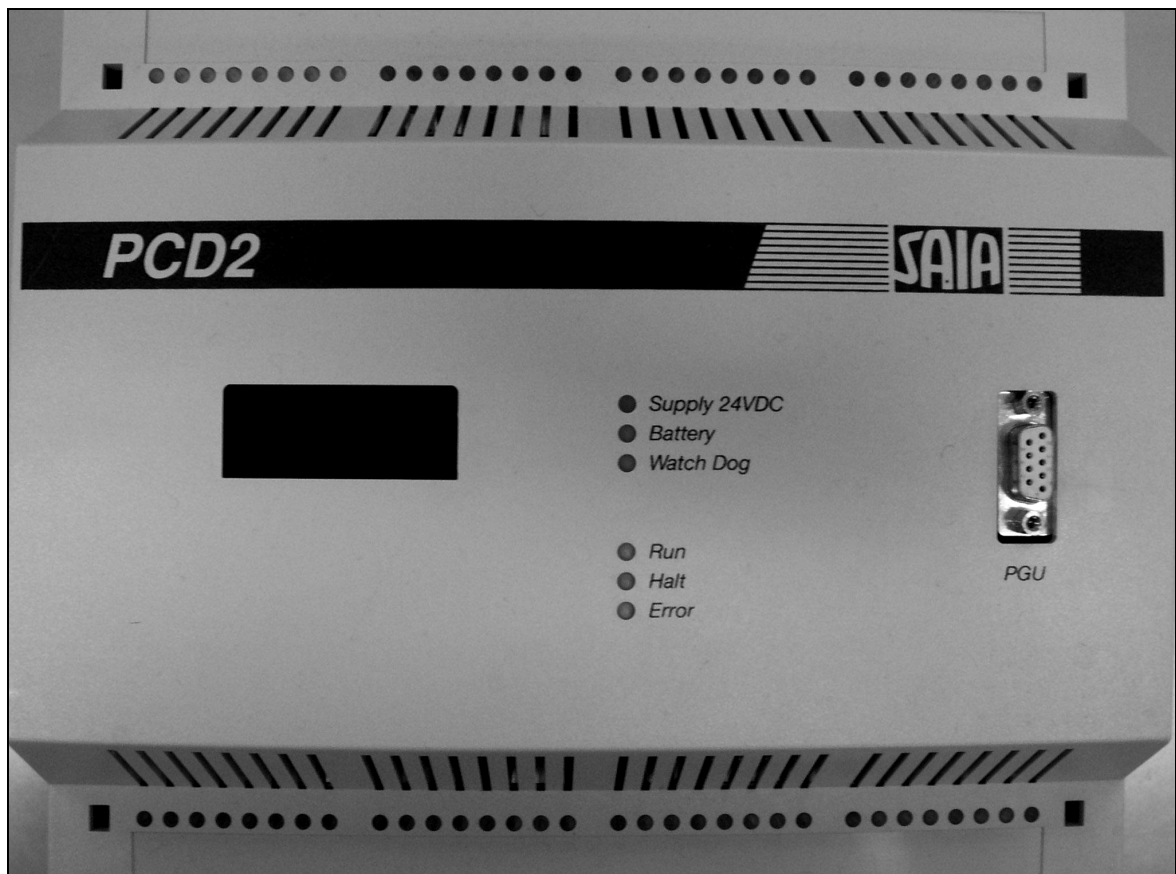
Obr. 10 Pohľad na programovateľný automat SAIA PCD2
