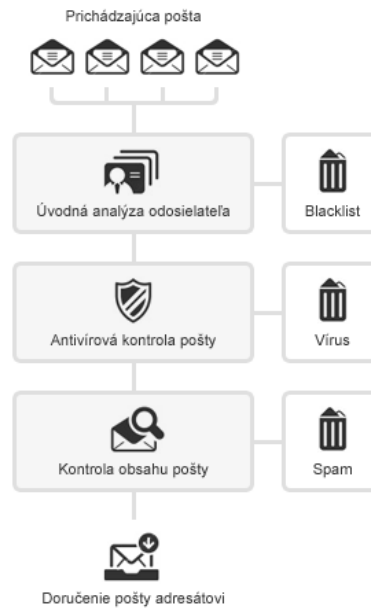
Obr. 35 Schéma fungovania Mail Gateway
