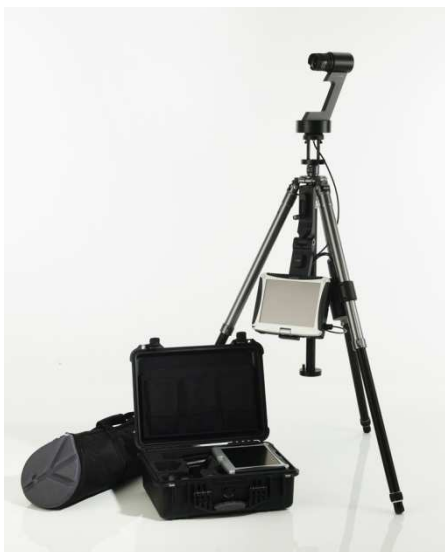
Obrázek č. 1 – sférická kamera na stativu s ovládacím PC a ochranným obalem – zdroj:
