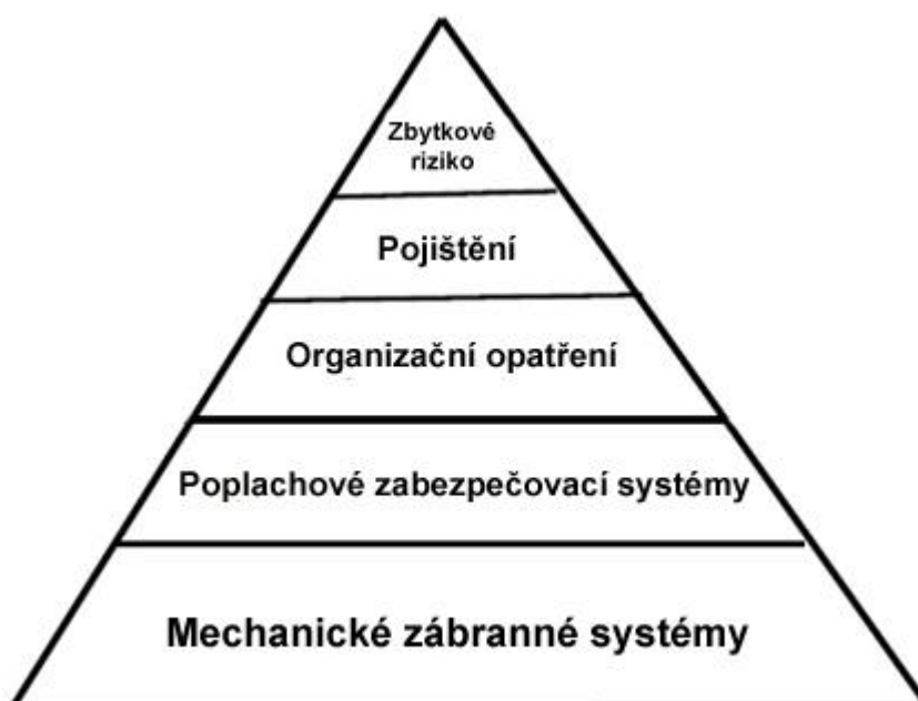
Obrázek 10: Posloupnost procesů při zabezpečování objektu
