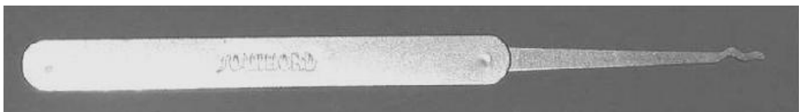
Obrázek 16: Planžeta ve tvaru Snake
