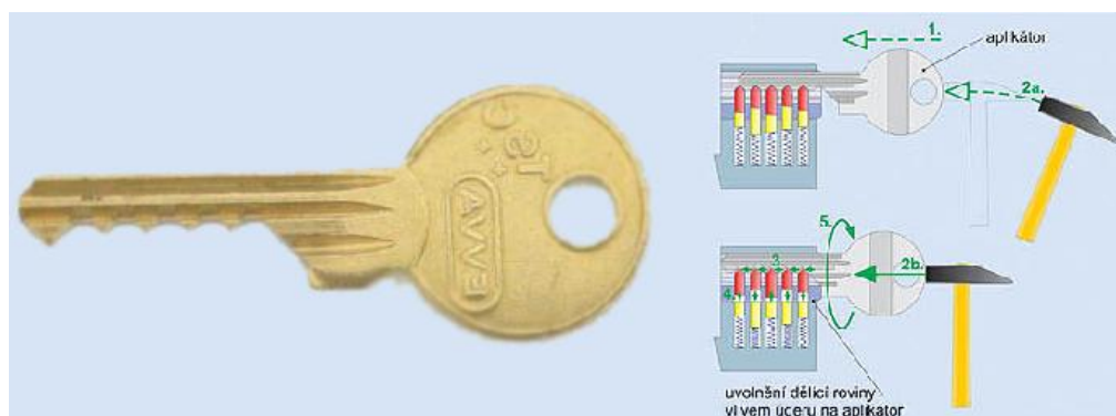
Obrázek 18: Bump key a jeho aplikace na zámek
