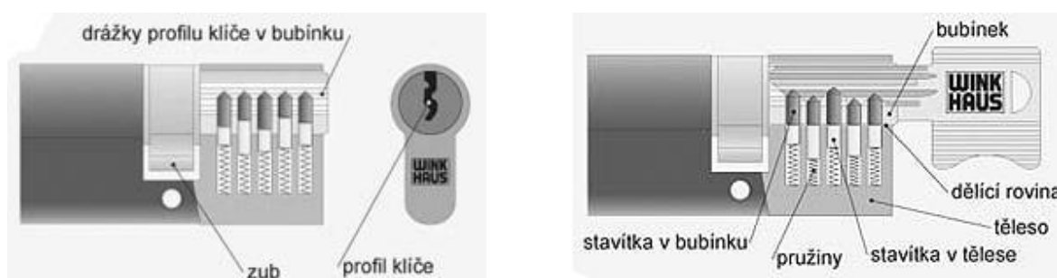
Obrázek 29: Popis součástí cylindrické vložky
