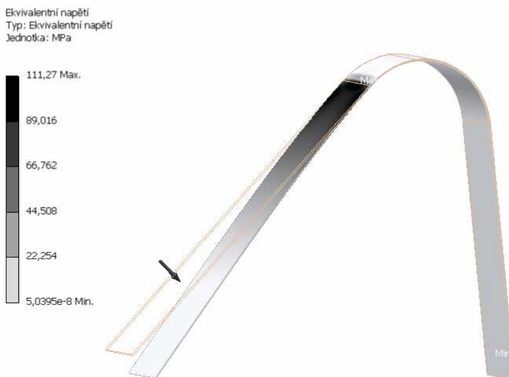
Obr. 16 Ekvivalentní napětí pružiny
