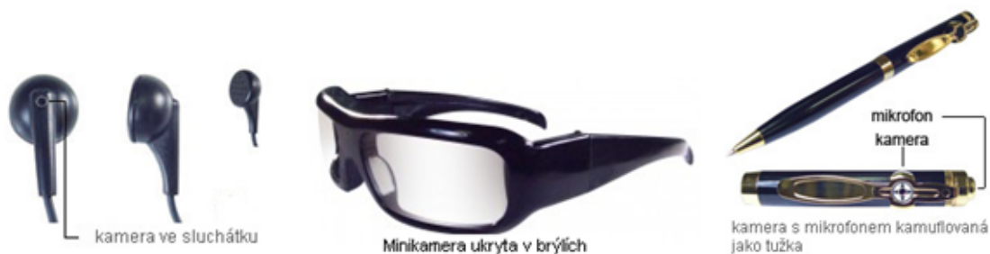
Obr. 20 Umístění minikamery HI-RES [7]
