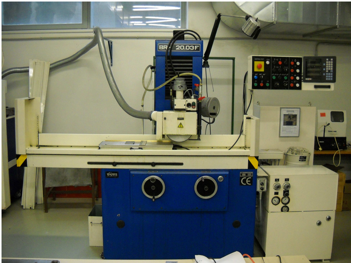
Obr. 15. Rovinná horizontální bruska BRH 20.03F
