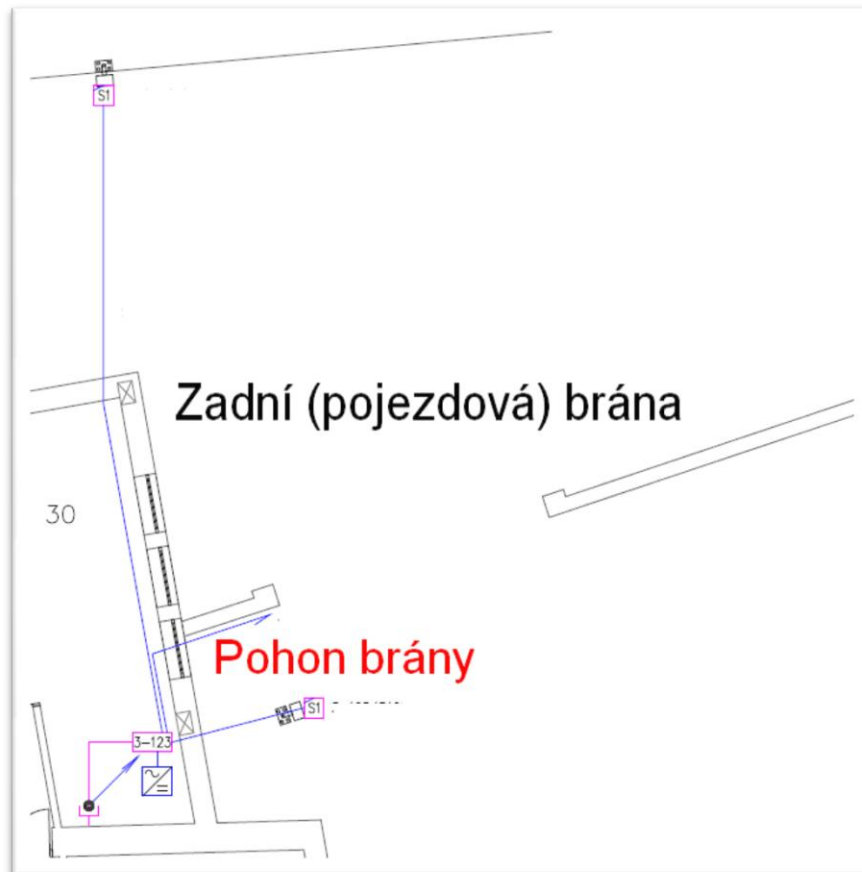
Obr. 30. Rozmístění prvků s kabeláží (část 3)
