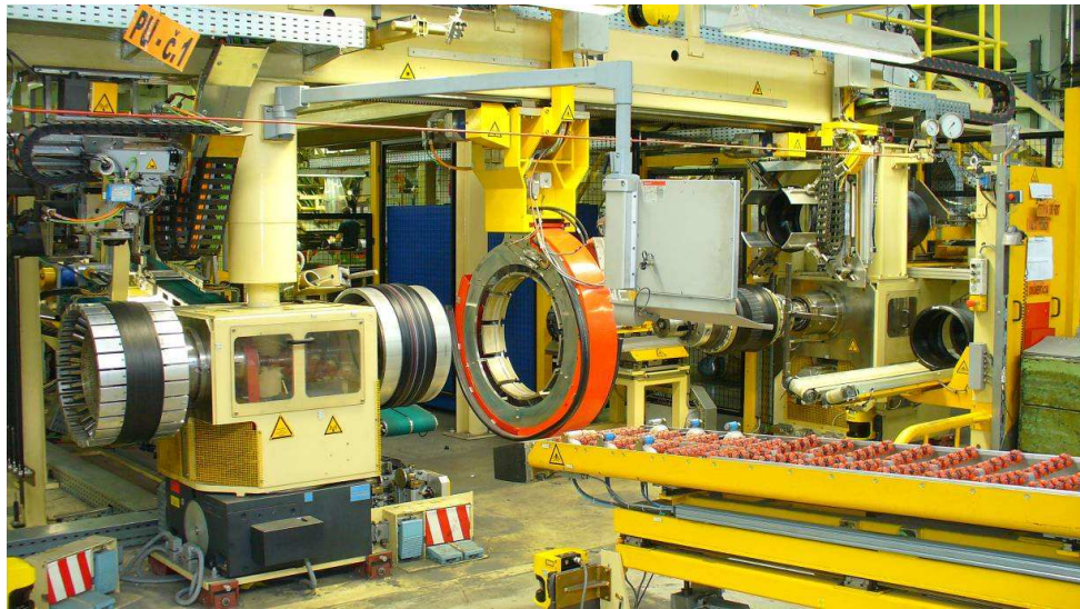
Obr. 13 Konfekčná linka KM-PU, časť PU [VI. spracovanie]
