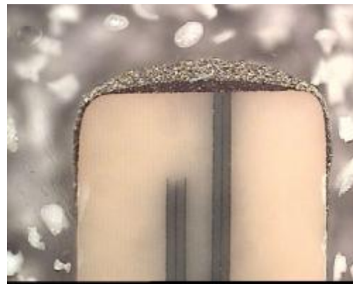
Obr. 26b. Řez terminací – Material SE_EC1
