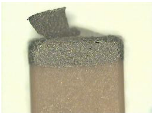
Obr. 25a. Oddělená platingová vrstva od polymer-stříbrné terminace– Materiál SE_EC2
