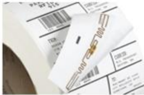
Obr. 2-15 Příklad Smart-label RFID tagu
