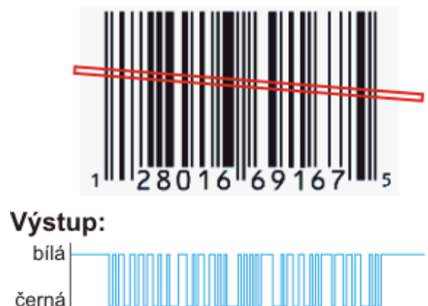
Obr. 3-2 1D snímání čárového kódu lineárním CCD
