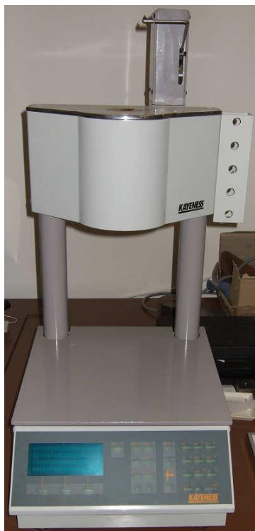
Obr. 34 Výtlačný plastometr DYNISCO KAYENESS LMI 4003
