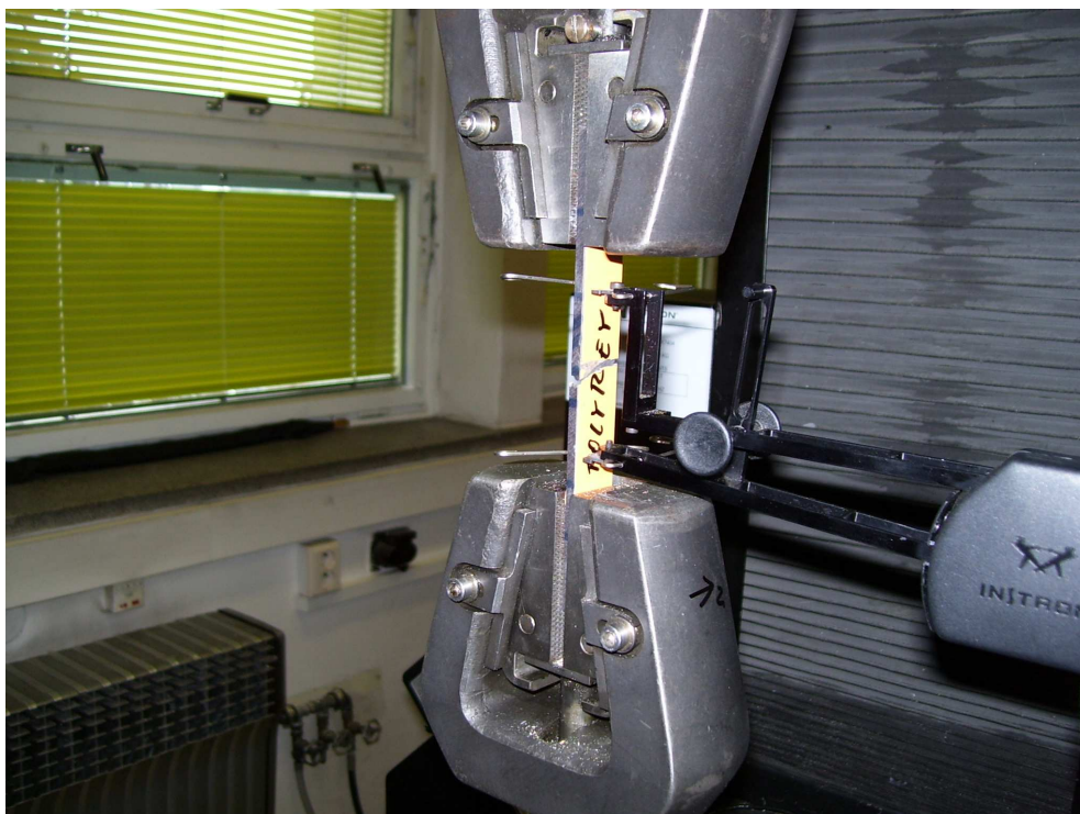
Obrázek 20 Upnutí zkušebního tělesa v čelistech stroje
