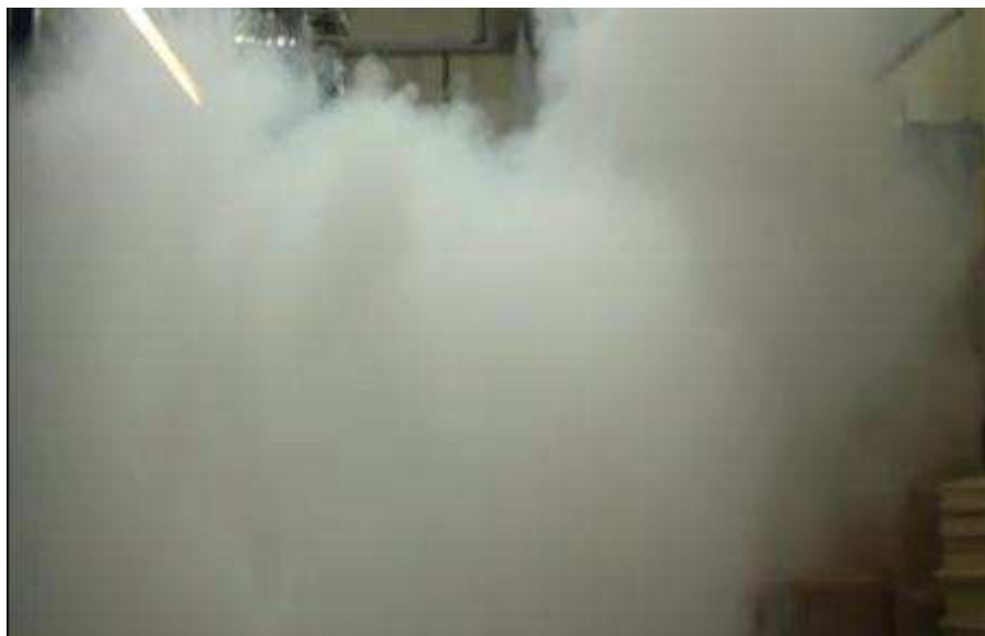
Obrázek 27 Distribuce mlhy přímo z generátoru [4]
