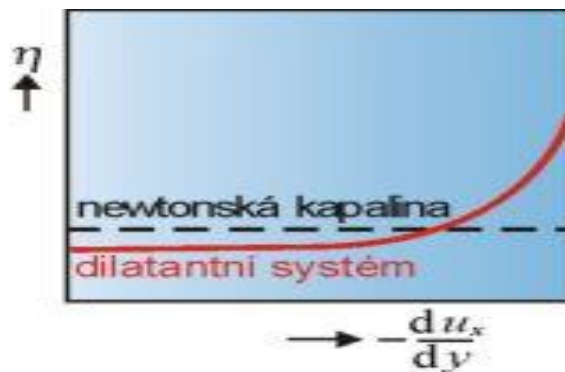
Obr. 15 Průběh viskozity dilatantní a newtonské kapaliny [21]
