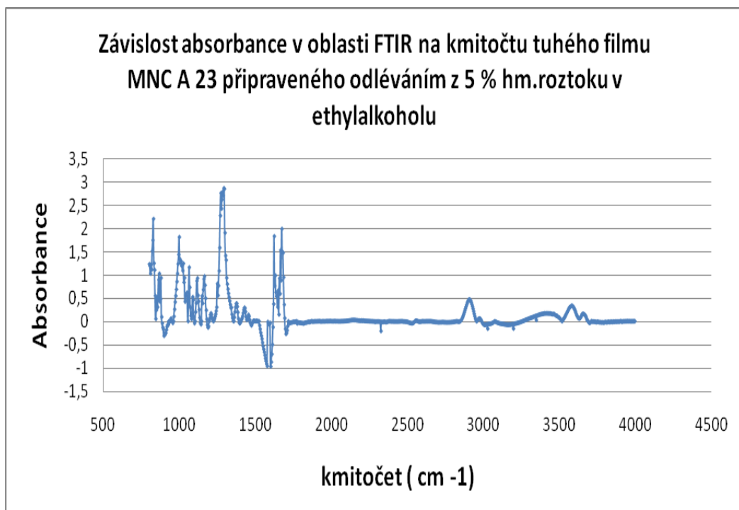
Obr. 56 Měření FT–IR tuhého filmu MNC A23 rozpuštěného v etylalkoholu
