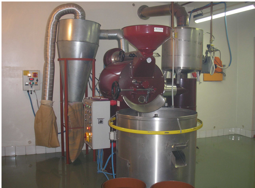
Obrázek č. 25 Pražicí stroj „Petroncini“ s dávkou (šarží) na 15 kg [24].
