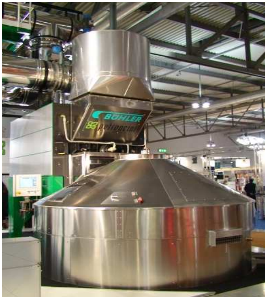
Obrázek č. 26 Velkokapacitní pražírna „Böhler-Petroncini“ dávka pražení 250, 400, 660 kg [20].
