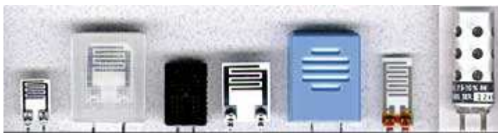
Obr. 3. Odporové senzory vlhkosti
