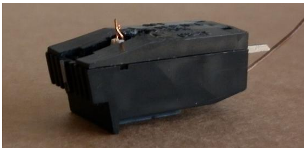
Obrázek 15.: Krystalová přenoska
