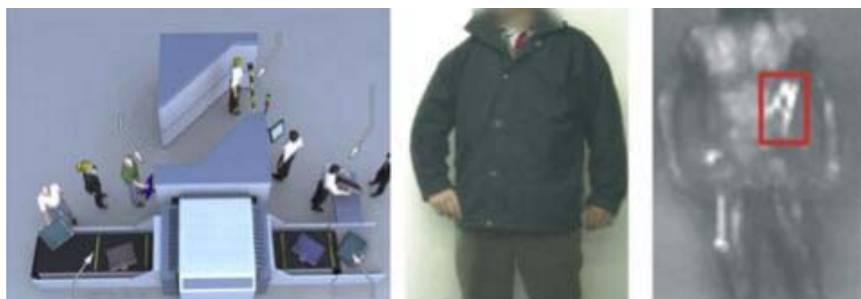
Obr. 20. Tunel s milivizí a pořízený snímek [4]
