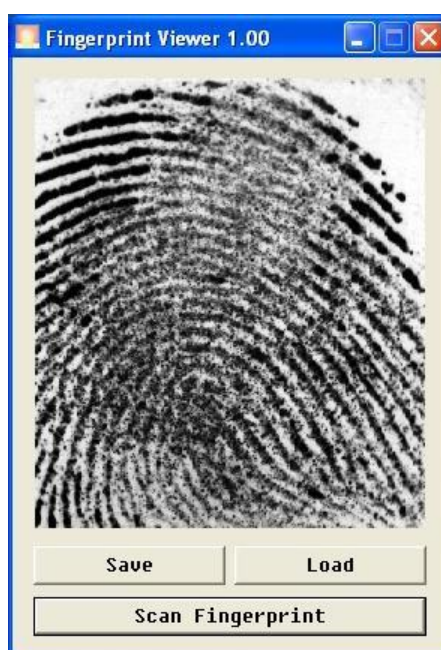
Obr. 38 Ukázka skenu prstu - znečištění vlivem prachu
