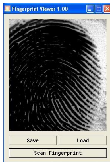
Obr. 39 Ukázka skenu prstu - vliv vlhkosti bříška prstu
