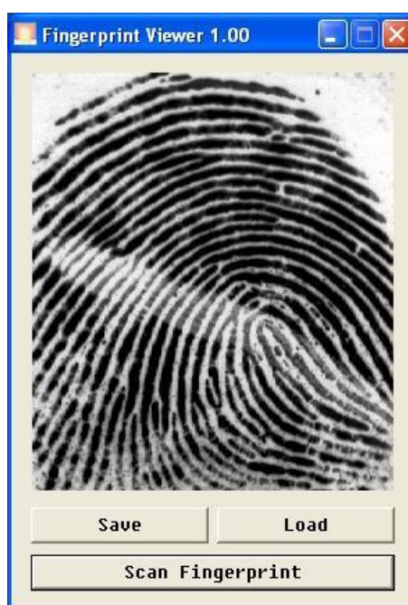
Obr. 37 Ukázka skenu prstu - znečištění lihovým fixem
