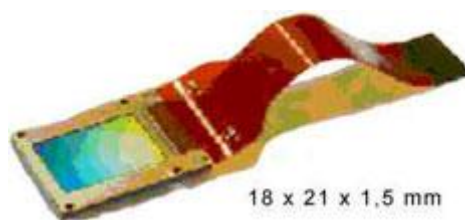
Obr. 15 Kapacitní snímač otisků - pohled na čip
