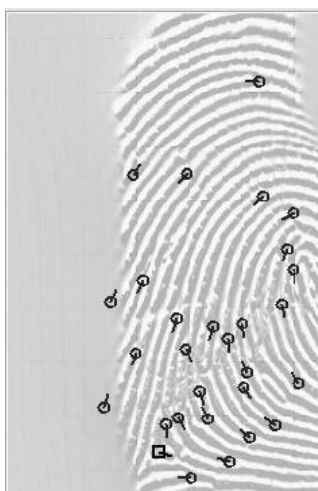
Obr. 12 Chyba vlivem částečného překrytí prstu
