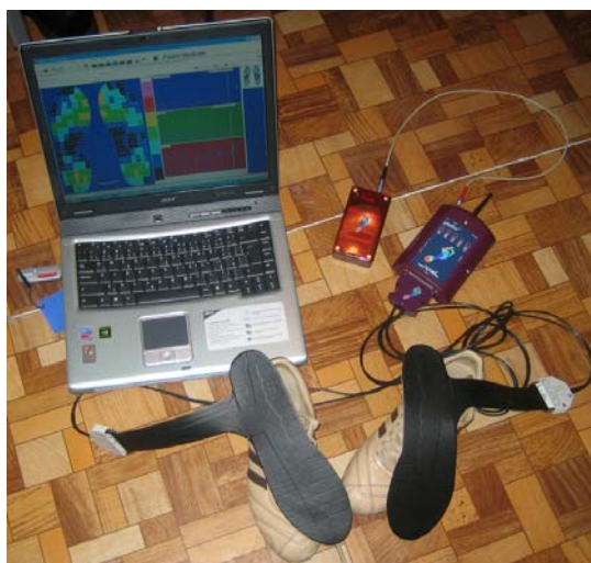
Obrázok 5. Merací prístroj PEDAR ®
