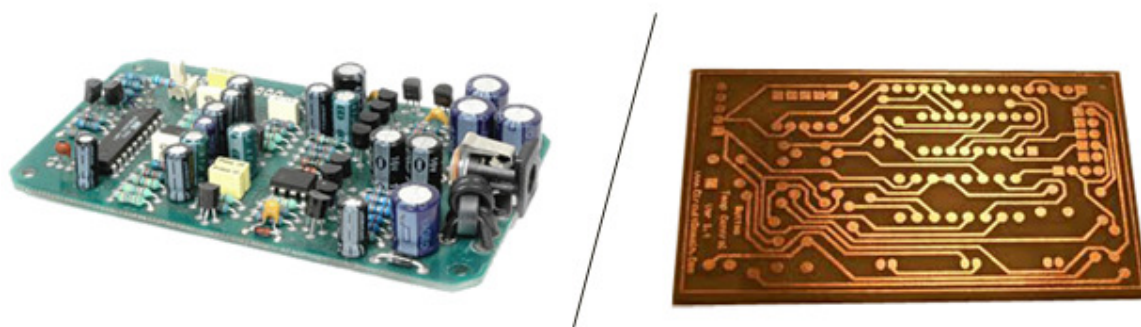
Obrázek 12 – Typicky osázená DPS / vodivé cesty na neosázené DPS [36, 37]
