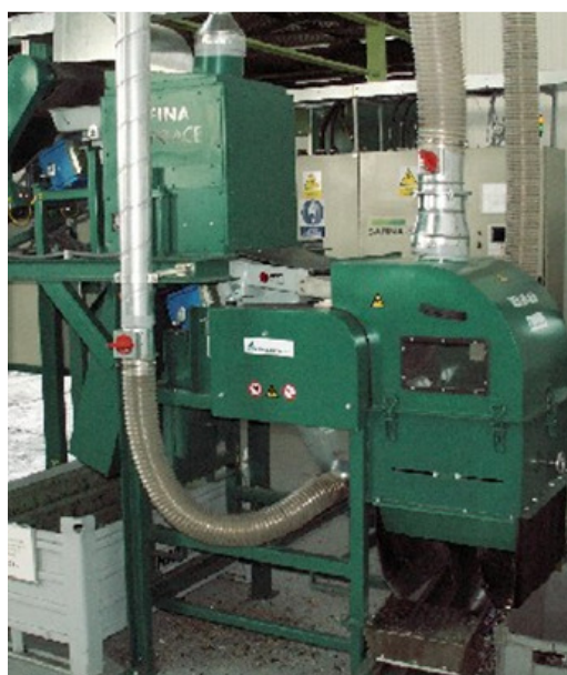
Obrázek 5 – Elektrodynamický separátor – na zpracování DPS [27]
