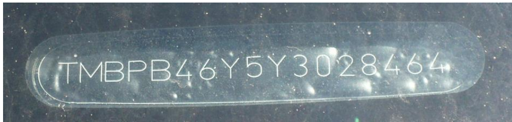
Obr. 57. VIN vozidla Škoda Fabia Classic, umístěné za čelním sklem
