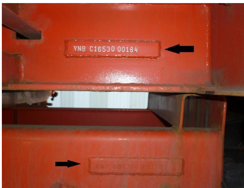
Obr. 75. Umístění identifikačních čísel podvozku návěsu
