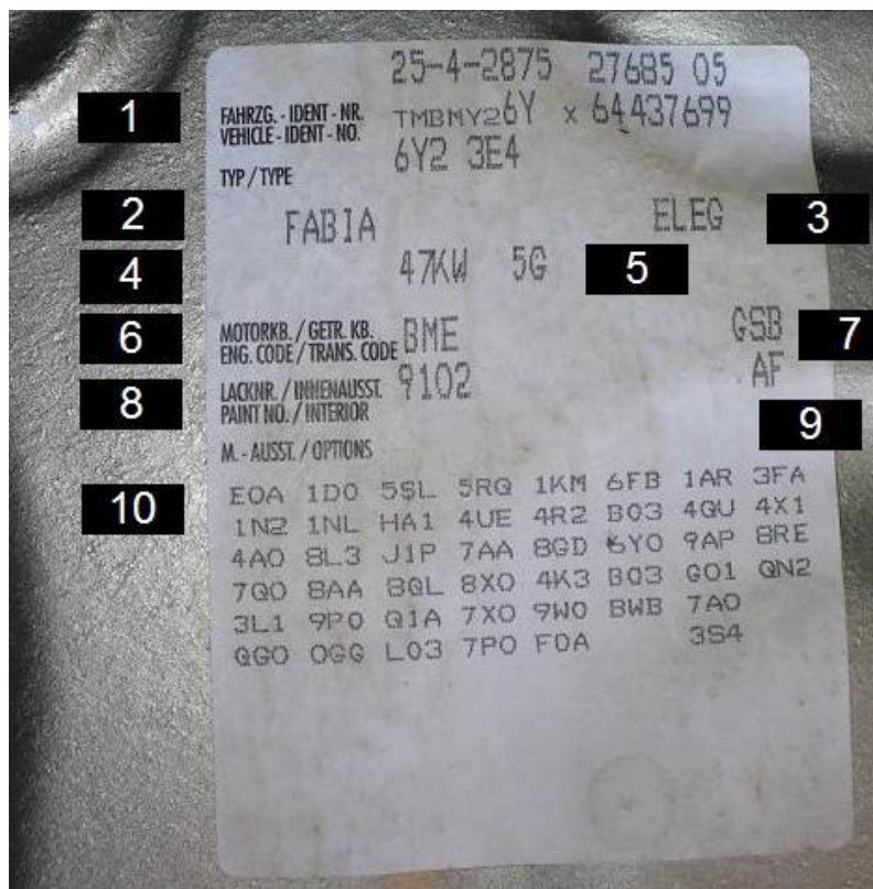
Obr. 43. Datový (homologační) štítek vozidla Škoda Fabia
