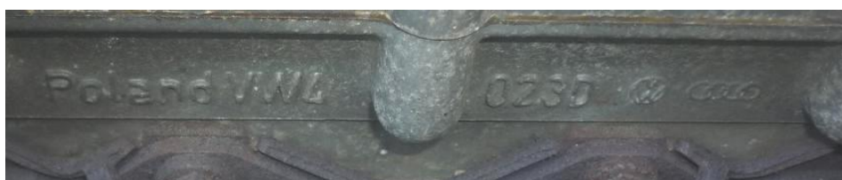
Obr. 45. Označení typu motoru vozidla Škoda Roomster
