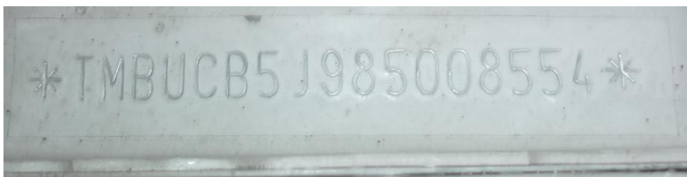
Obr. 65. VIN vozidla Škoda Roomster
