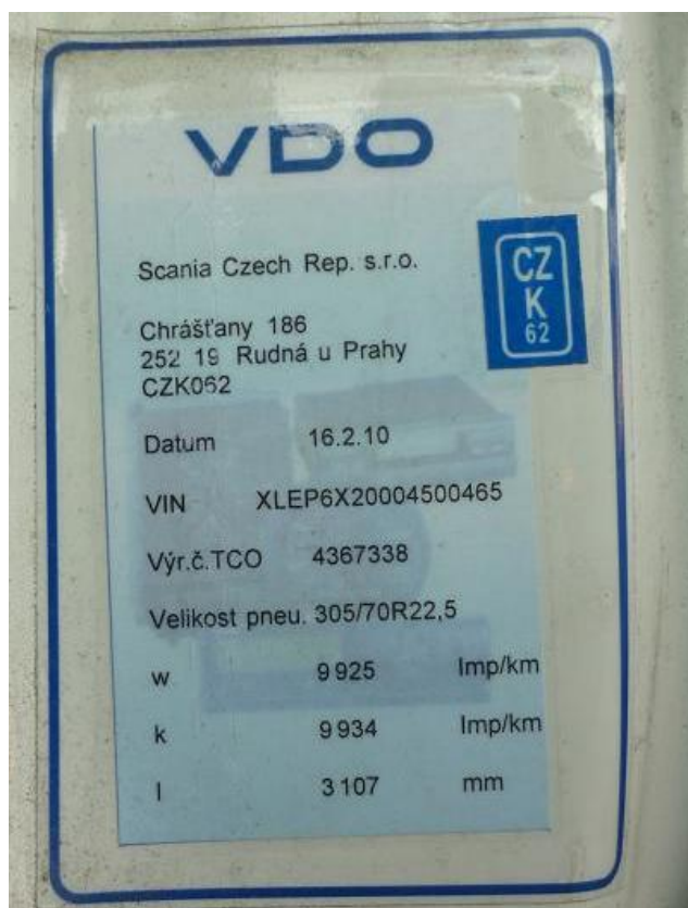
Obr. 77. Identifikační štítek kamionu Scania
