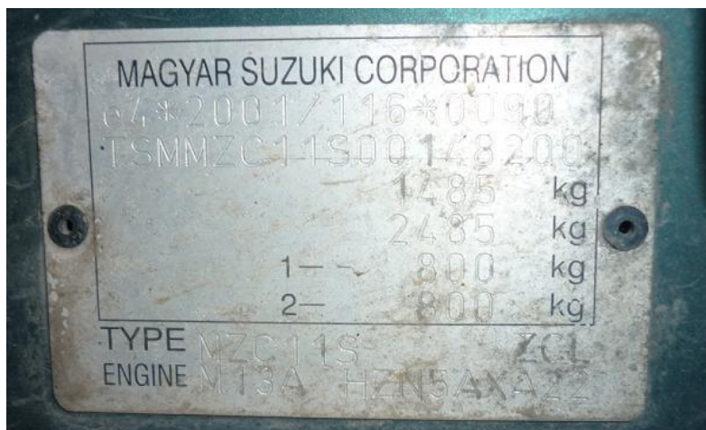
Obr. 37. Typový štítek vozidla Suzuki Swift
