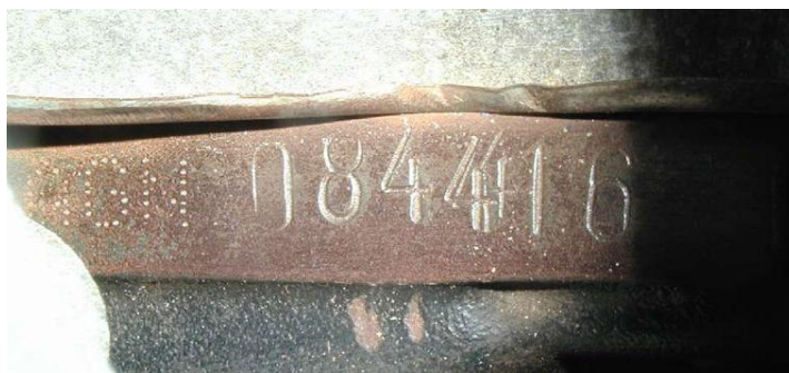
Obr. 23. Zcela zřejmá přeražba čísla motoru [32]
