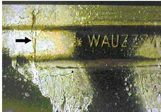
Obr. 21. Navařené číslo VIN na voze AUDI [2]
