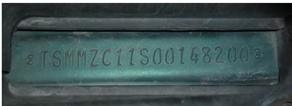
Obr. 66. VIN vozidla Suzuki Swift
