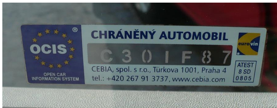
Obr. 76. Systém SBZ OCIS (vypískovaný alfanumerický kód)
