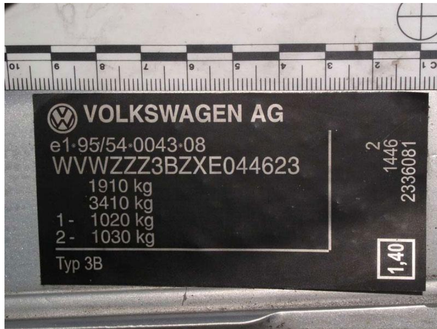
Obr. 20. Ukázka padělaného typového štítku vozidla Volkswagen passat [31]
