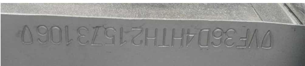
Obr. 60. VIN vozidla Peugeot 407, umístěné v motorovém prostoru
