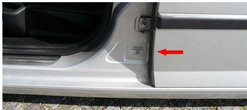
Obr. 34. Umístění typového štítku vozidla Peugeot 407
