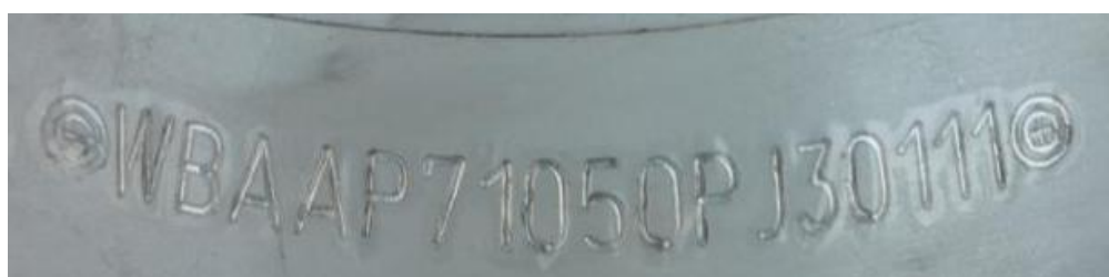
Obr. 62. VIN vozidla BMW 320
