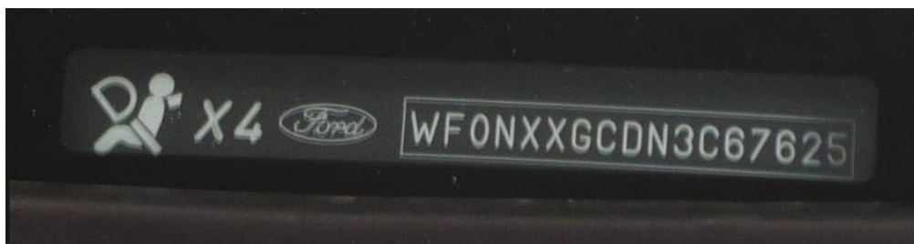
Obr. 67. VIN vozidla Ford Focus
