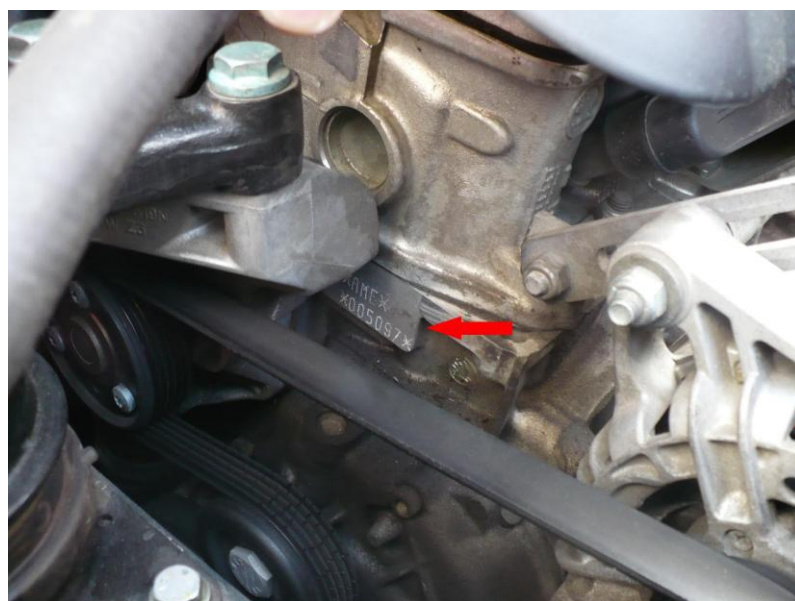
Obr. 49. Umístění výrobního čísla motoru vozidla Škoda [35]
