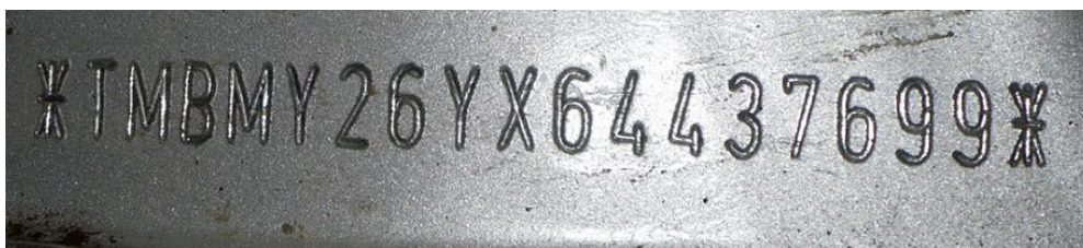
Obr. 55. VIN vyražené v motorovém prostoru u vozidla Škoda Fabia
