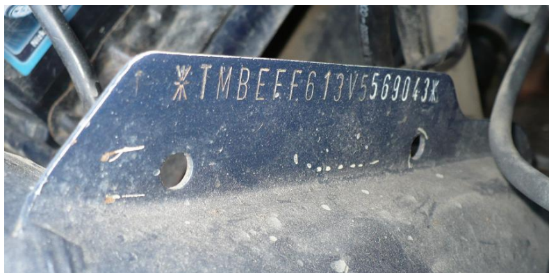
Obr. 64. VIN vozidla Škoda Felicia
