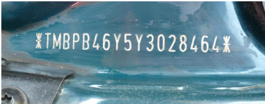
Obr. 58. VIN vozidla Škoda Fabia Classic, umístěné v motorovém prostoru
