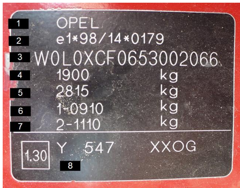
Obr. 33. Typový štítek vozu Opel Combo CDTI
