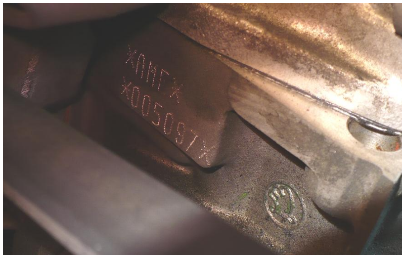
Obr. 48. Výrobní číslo motoru vozidla Škoda Fabia
