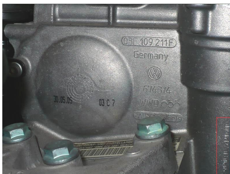
Obr. 47. Označení motoru vozidla Škoda Fabia Elegance
