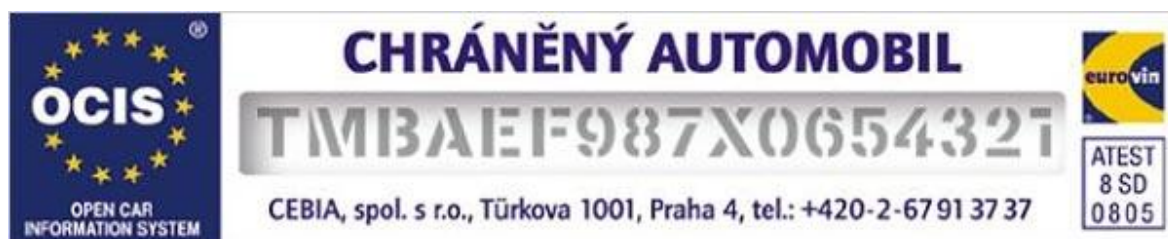
Obr. 19. Ukázka označení skla systémem EUROVIN OCIS [28]
