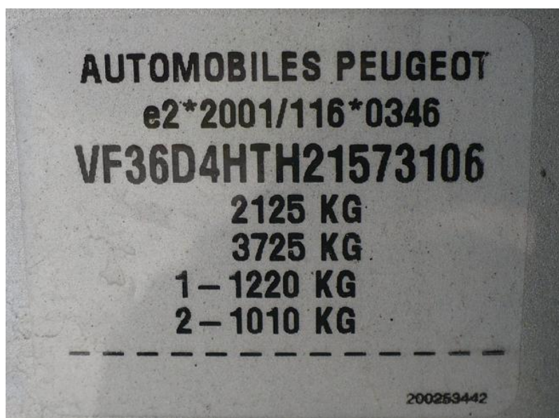
Obr. 35. Typový štítek vozidla Peugeot 407
