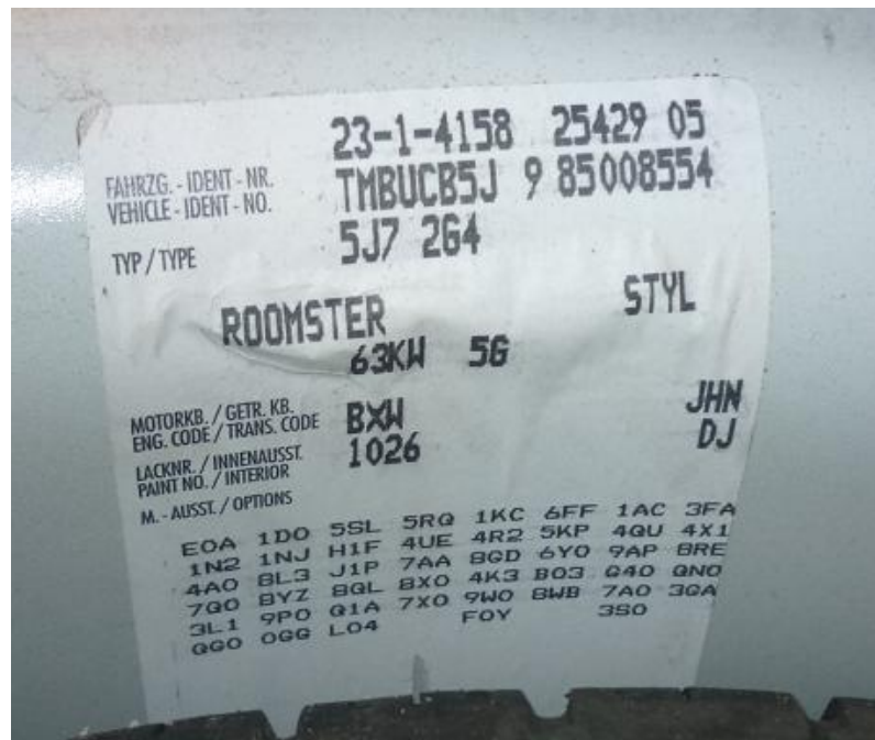
Obr. 42. Datový štítek vozidla Škoda Roomster
