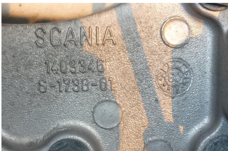
Obr. 72. Levý konstrukční prvek kamionu Scania s výrobním číslem
