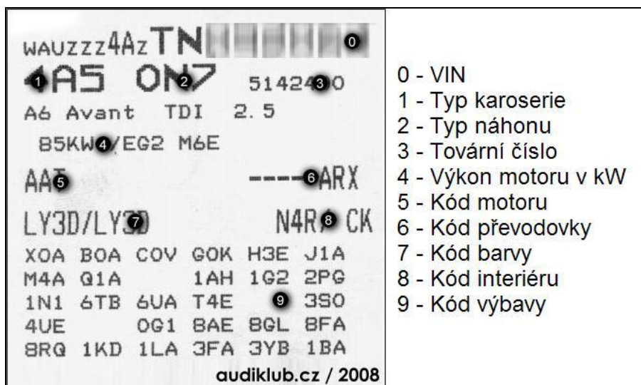
Obr. 16. Typový štítek vozu Audi [23]
