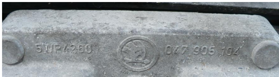
Obr. 46. Označení typu pohonné jednotky u vozidla Škoda Felicia
