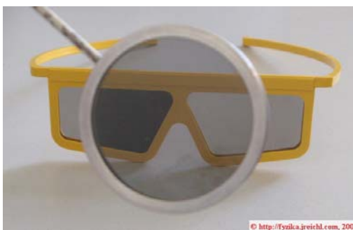
Obr. 3: Propustnost dvojice pootočených polarizačních filtrů
