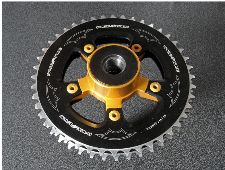
Obr. 36. Dvojitý převodník, jehož unašeč je vyfrézován z jednoho kusu hliníku, uvnitř je nalisována volnoběžka.
