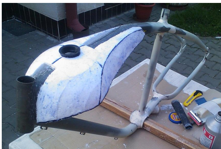
Obr. 38. Tvarování palivové nádrže.
