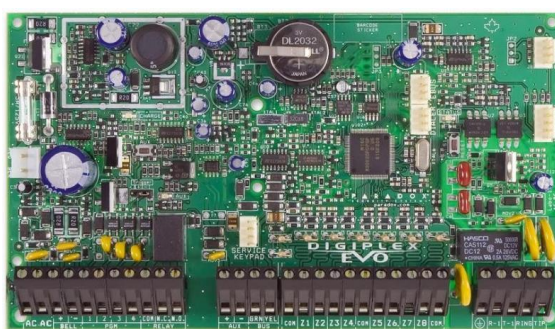
Obrázek 4. Ústředna PZTS EVO 192 [15]
